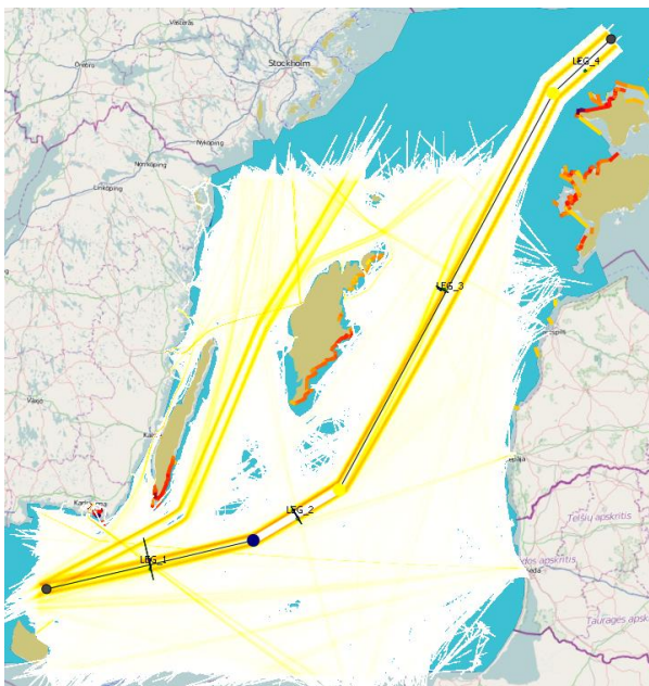
Figur 11. Resultat av IWRAP-beräkning av kollisionssannolikhet och grundstötningssannolikhet för omdirigeringsalternativ 1, djupvattenleden.
