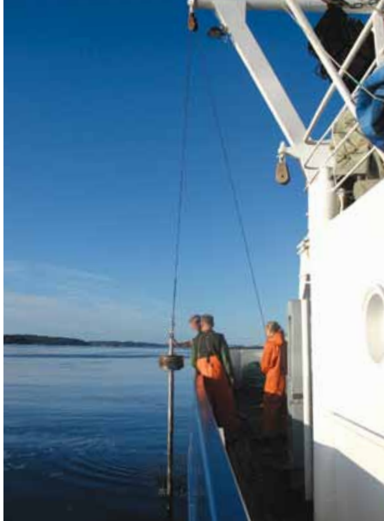
Provtagning av sedimentkärnor från forskningsfartyget Skagerak. Bara en halvmeter ned i sedimenten är man ofta 200 år bakåt i tiden ute på Kattegatts och Skagerraks bottnar. Inne i bohuslänska fjordar når man kanske 50 år tillbaka vid samma sedimentdjup. Skillnaden beror på att sedimentationshastigheten är olika på olika platser.
