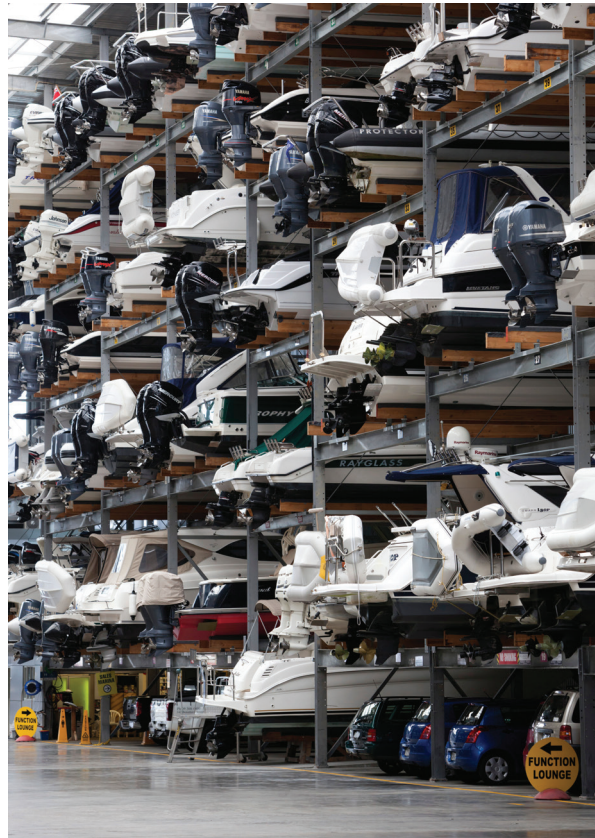
FIGUR 7.1 I bl.a. USA är det vanligt att marinor har s.k. dry-stackförvaring av båtar på flera våningar höga hyllplan. Båtarna sjösätts, tas upp och placeras på hyllorna med specialbyggda gaffeltruckar. Dessa marinor har ett s.k. "launch-on-demand" system där båtägaren ringer in till marinan när båten ska användas, varefter marinan sjösätter båten vid bryggan vid önskad tid. Foto: Alamy
