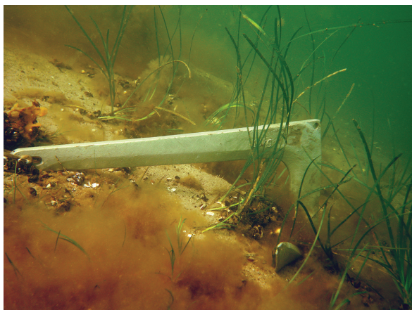
FIGUR 5.5 Ett så kallat Bruce-ankare i en ålgräsäng utanför en populär badstrand i Trosa skärgård. Skador från ankare uppkommer när ankare slår i botten, men främst när ankaret dras in. Foto: Joakim Hansen.
